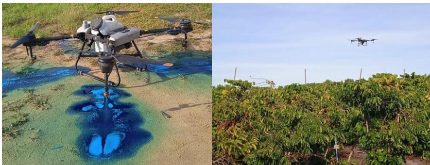
Esta ARP possui um tanque com capacidade para 10,0 litros, o qual foi rigorosamente regulado e calibrado antes das operações de pulverização. Além do reservatório para armazenamento dos produtos, a aeronave conta com uma bomba de água, um sistema de tubulação para a circulação do líquido, controle eletrônico, válvulas e outros componentes essenciais. As pontas de pulverização da ARP estão posicionadas de forma equidistante e
