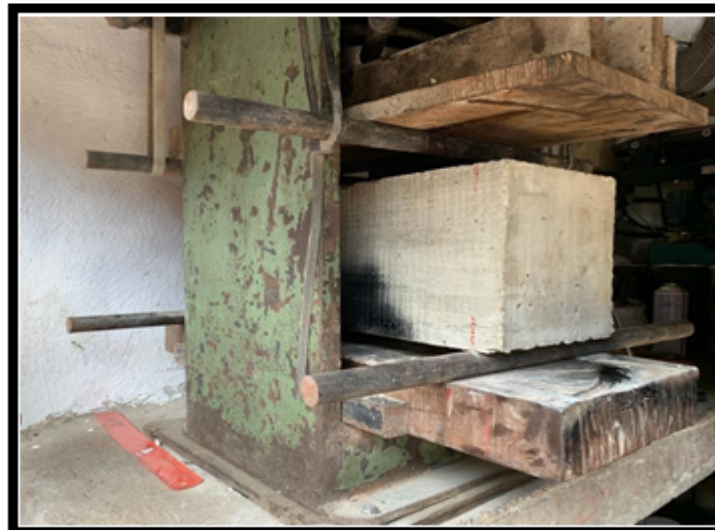
Figura 22 - Ensaio de flexão a quatro pontos
