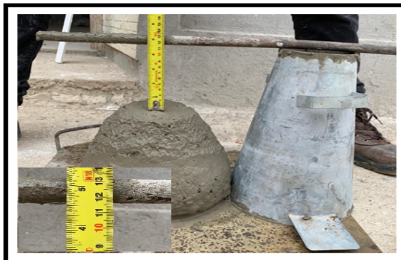
Figura 10 - Resultado do teste Slump
