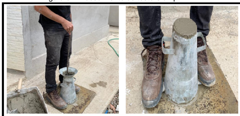
Figura 9 - Procedimento do teste Slump
