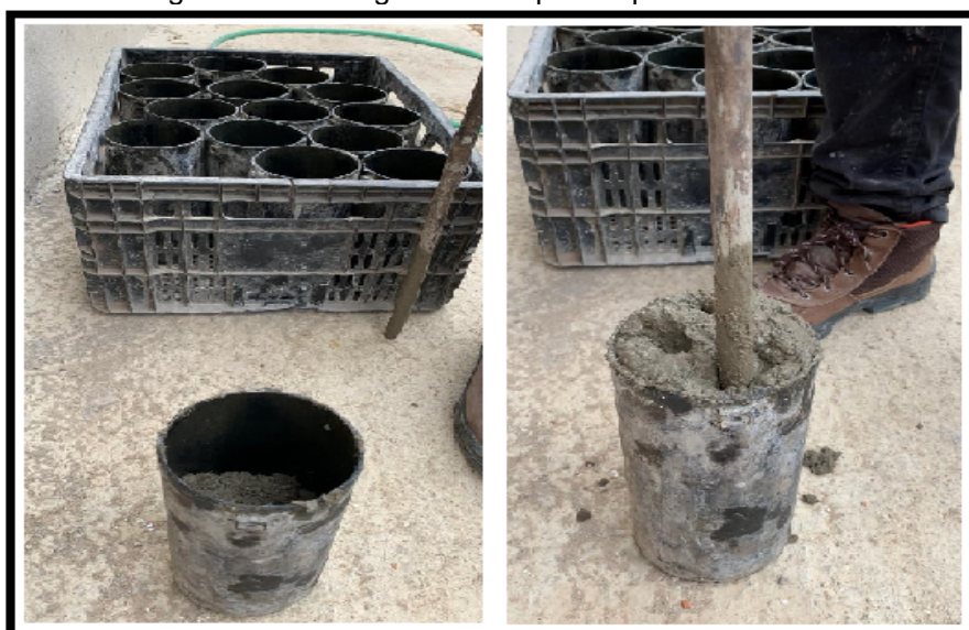
Figura 11 - Moldagem dos corpos de prova cilíndricos
