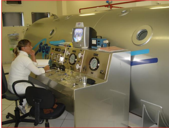
Fig.9: Profissional responsável gerenciando painel de controle da câmara hiperbárica. Fonte: Autores.
