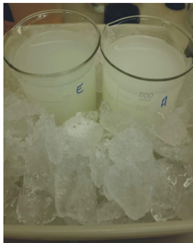
Figura 2: Mistura da solução filtrada com acetona e etanol (processo de cristalização da glicina) (Arquivo pessoal)
