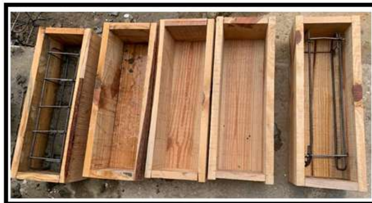
Figura 6 - Fôrma de madeira Pinus
