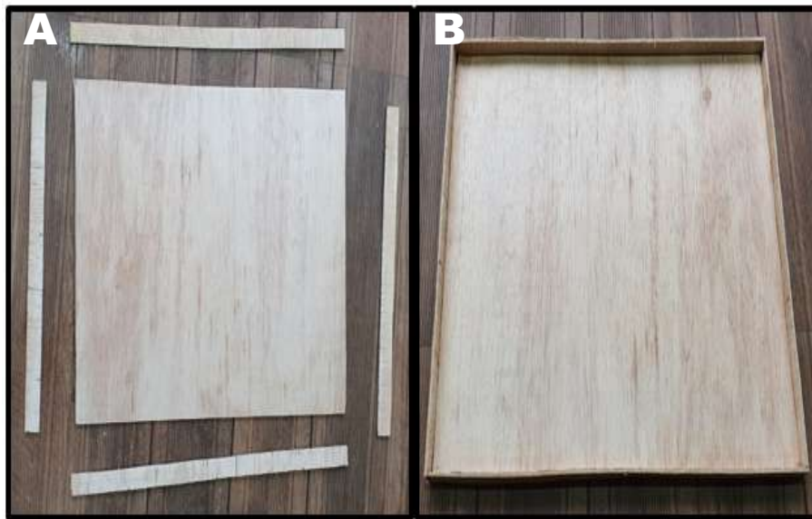
Figura 3 - Construção do piso para maquete
