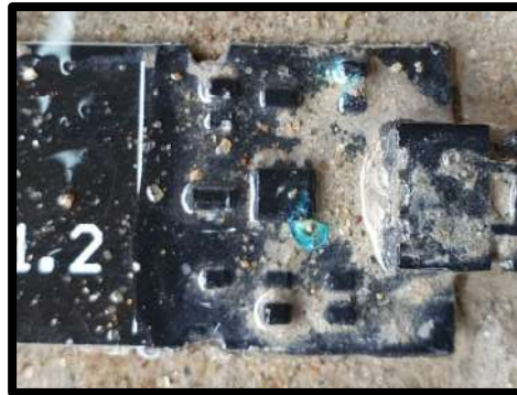
Figura 34 - Zinabre presente na eletrônica do sensor
