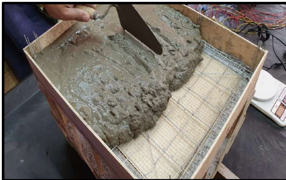
Figura 31 - Despejo de concreto na maquete final
