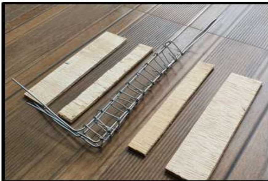
Figura 4 - Construção dos pilares de sustentação
