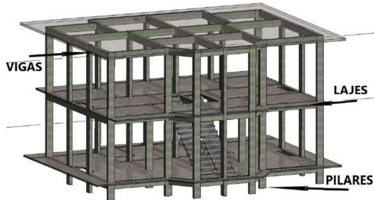
Figura 3 : Elementos de concreto armado, Pilares, Vigas e Lajes
