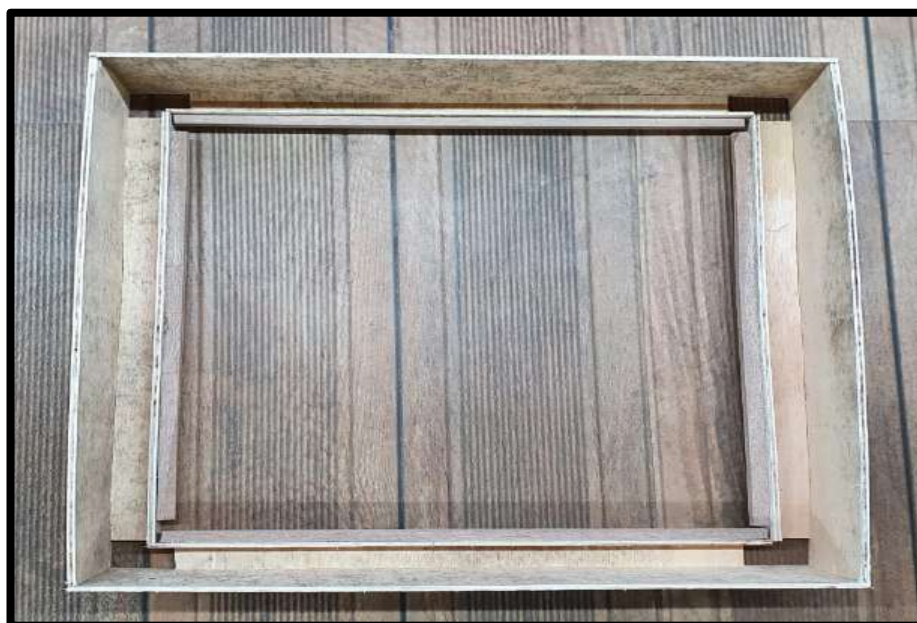
Figura 8 - Forma para laje de teste
