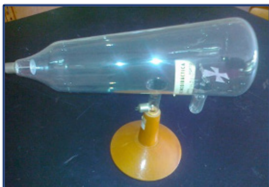
Figura 4 – Ampola de Crookes
