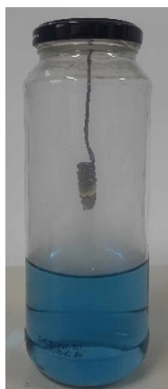
Figura 11b – Formação dos gases oriundos da queima do enxofre.
