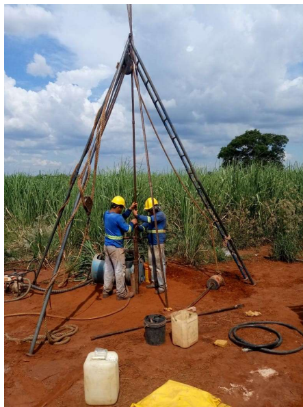
Figura 4 – (a) Sondagem a percussão e (b) Elementos para realização de sondagem
