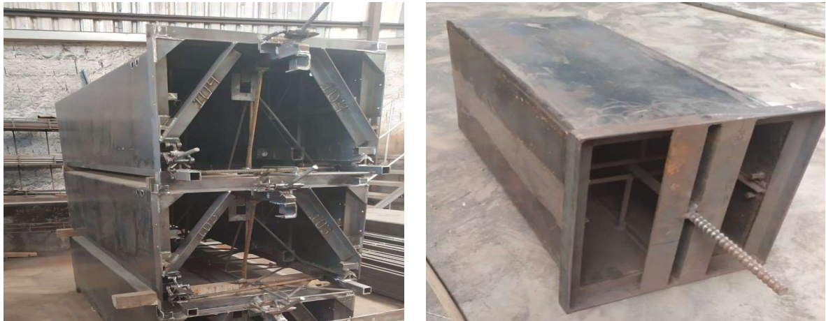
Figura 22 – (a) Fôrma de gaveta e (b) Fôrma de columbário
