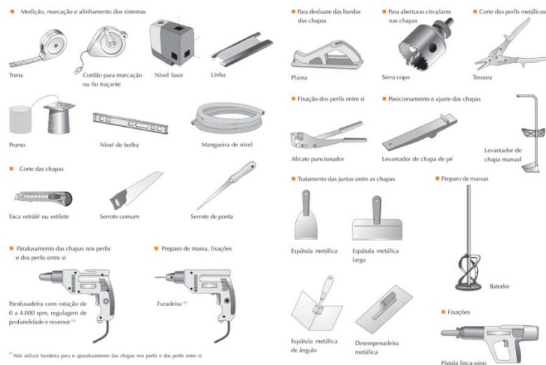
Figura 22 - Ferramentas utilizadas na montagem da estrutura drywall
