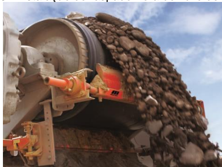
Figura 6 - Instalação do raspador fora do fluxo de material
