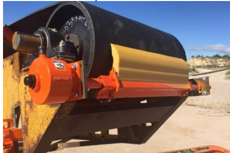
Figura 5 - Posicionamento do raspador no ciclo de retorno do transportador
