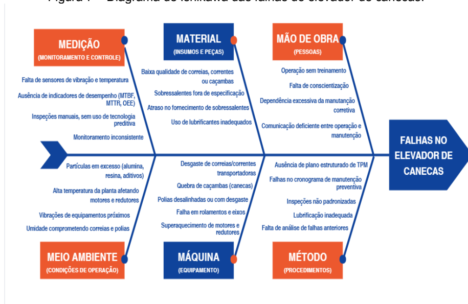
Figura 7 – Diagrama de Ishikawa das falhas do elevador de canecas.
