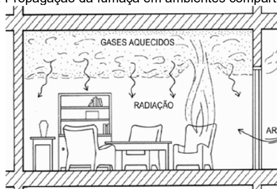
Figura 3: Propagação da fumaça em ambientes compartimentados
