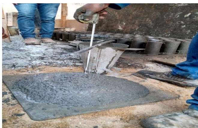
Figura 18- Teste do slump
