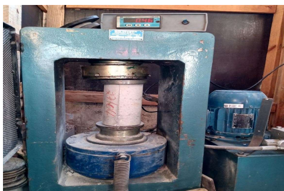
Figura 20 - Rompimento do corpo de prova
