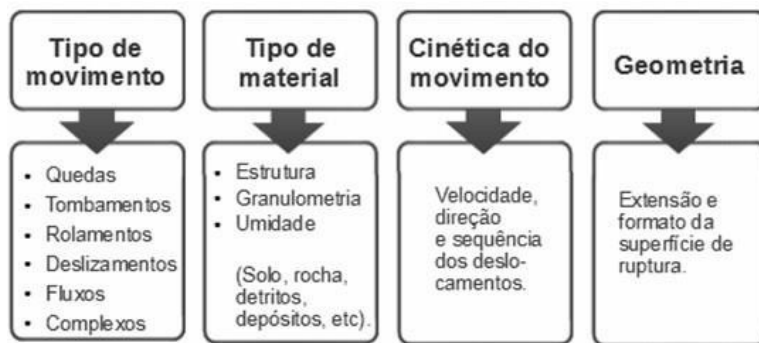
Figura 3 - Critérios para classificação de movimentos de massa ( Fundação Geo-Rio, 2014 – adaptado de Varnes,1978 & Augusto Filho,1992).
