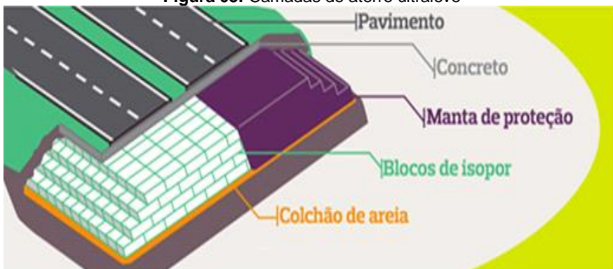
Figura 03: Camadas do aterro ultraleve
