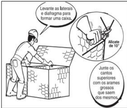
Figura 10: Gabião sendo desdobrado
