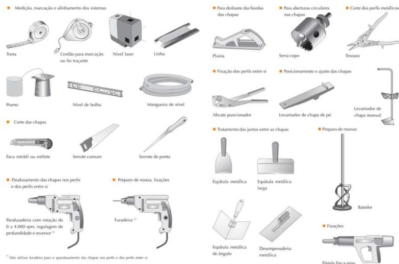
Fonte: Drywall | Componentes ferramentas para sistemas drywall
