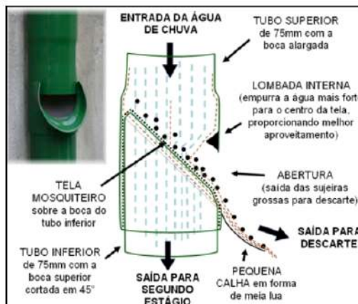
Figura 5: Filtro auto-limpante para água de chuva
