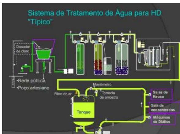
Figura 1: Detalhe do sistema de tratamento de água crua com a técnica de osmose reversa.
