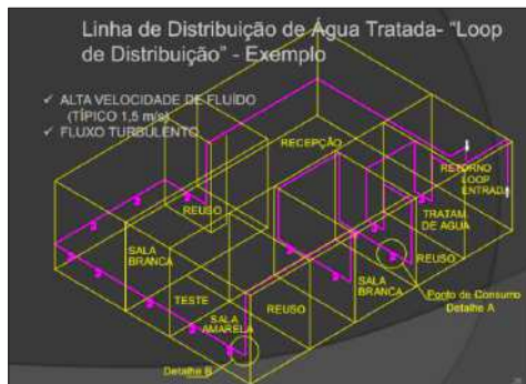
Figura 5: Detalhe do sistema PEX comumente utilizado para distribuição de água tratada no sistema looping, nos equipamentos de hemodiálise.
