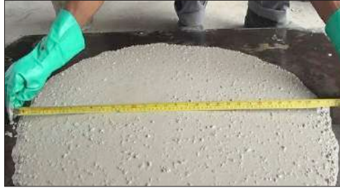
Figura 13: Concreto auto adensável
