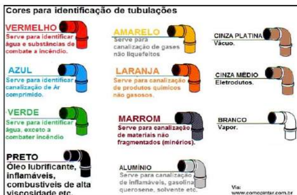
Figura 8: Cores de Identificação das tubulações
