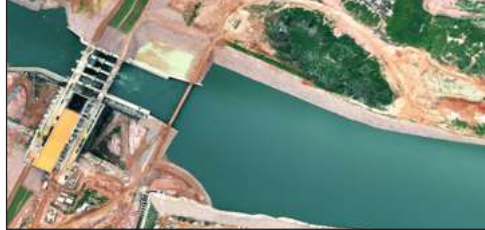
Figura 10: Imagem exemplificando ortomosaico com junção das imagens de um levantamento topográfico em uma hidrelétrica.
