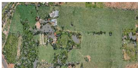
Figura 6: Exemplo nuvem de pontos fotogramétricos, vista plana pelo software Agisoft.
