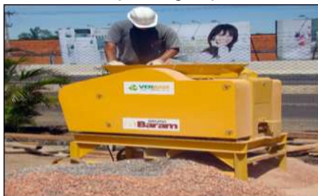
Figura 5: Equipamento de trituração e separação de entulhos de construção.
