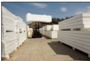
Figura 04: Carregamento de painéis por empilhadeira.
