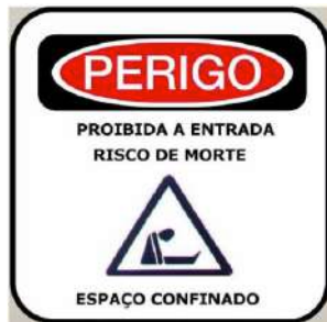
Figura 4: Sinalização para identificação de espaço confinado.
