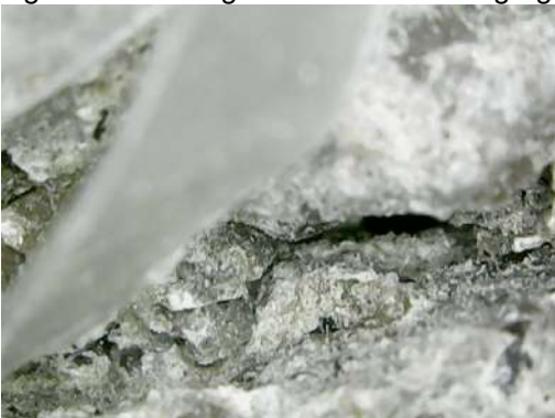
Figura 14 - Micrografia ilustrando a segregação dos componentes ao redor do PET
