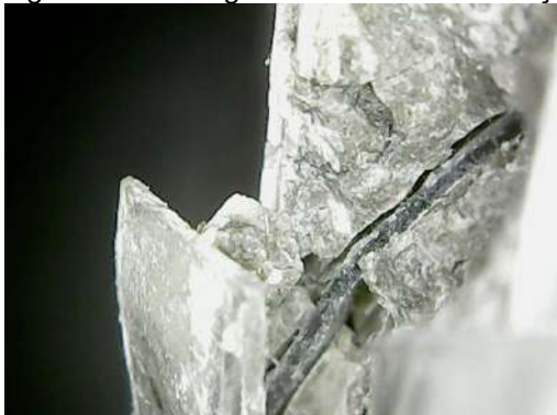
Figura 16 - Micrografia ilustrando a interação do PET com o concreto no traço com adição de 40%
