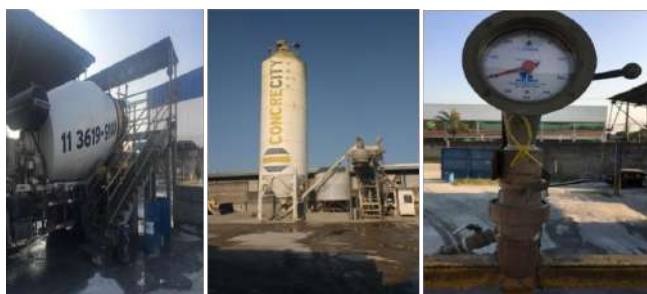
Figura 3 (A) Processo de dosagem do concreto; (B) Dosador de água; (C ) Dosagem de água
