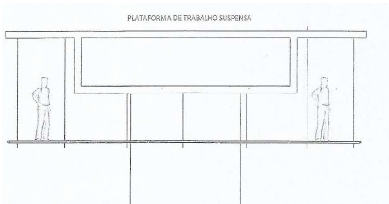
Figura 18 – Plataforma de trabalho suspensa Viaduto Padre João Musch Fonte: Defesa Civil de Nova Iguaçu
