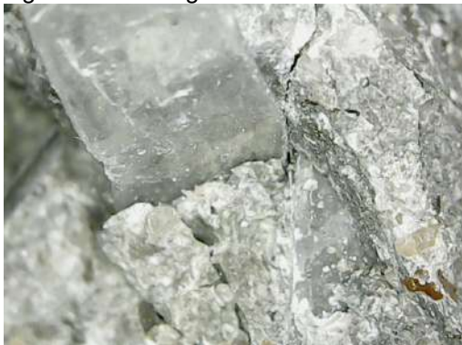
Figura 17 - Micrografia ilustrando o PET com microfissuras ao redor
