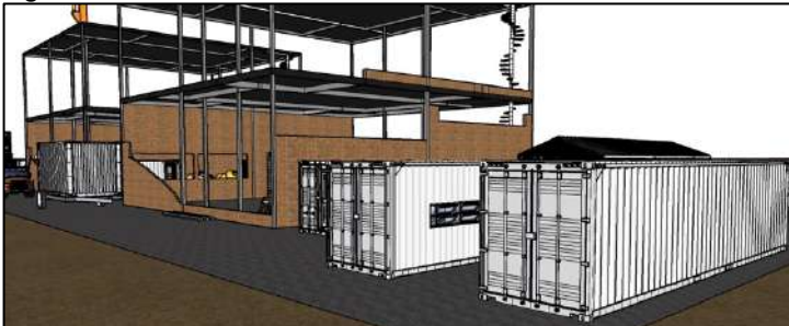
Figura 16: Canteiro de obras modular com containers
