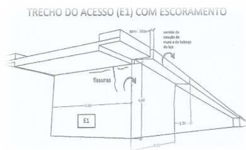
Figura 10 – Trecho do acesso (E1) com escoramento Viaduto Padre João Musch Fonte: Defesa Civil de Nova Iguaçu
