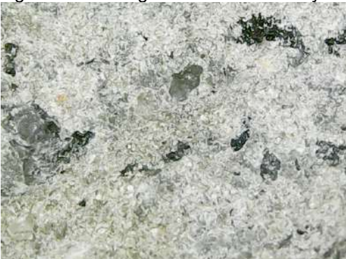
Figura 13 - Micrografia ilustrando o traço com adição de 40% de PET
