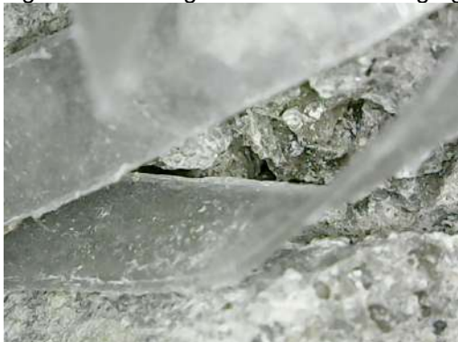
Figura 18 - Micrografia mostrando a segregação do concreto ao redor do PET
