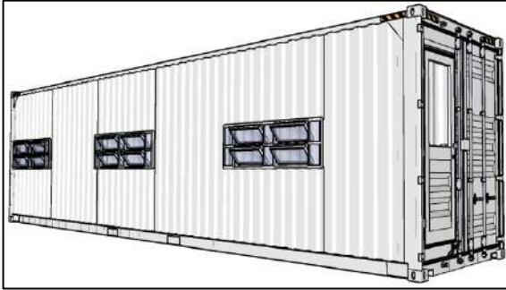
Figura 13: Vista 3d do refeitório em container
