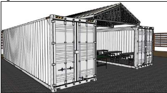
Figura 14: Telhado em módulos de container
