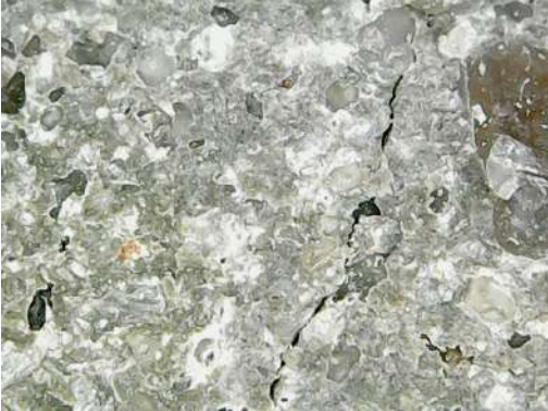
Figura 12 - Micrografia ilustrando o traço padrão de PET
