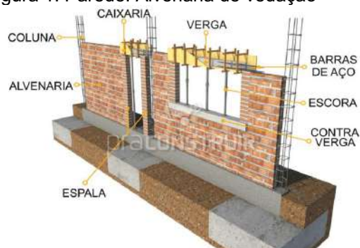
Figura 1: Parede: Alvenaria de vedação
