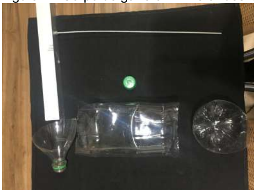
Figura 7 - Corpo de garrafa PET e o "desfiador"
