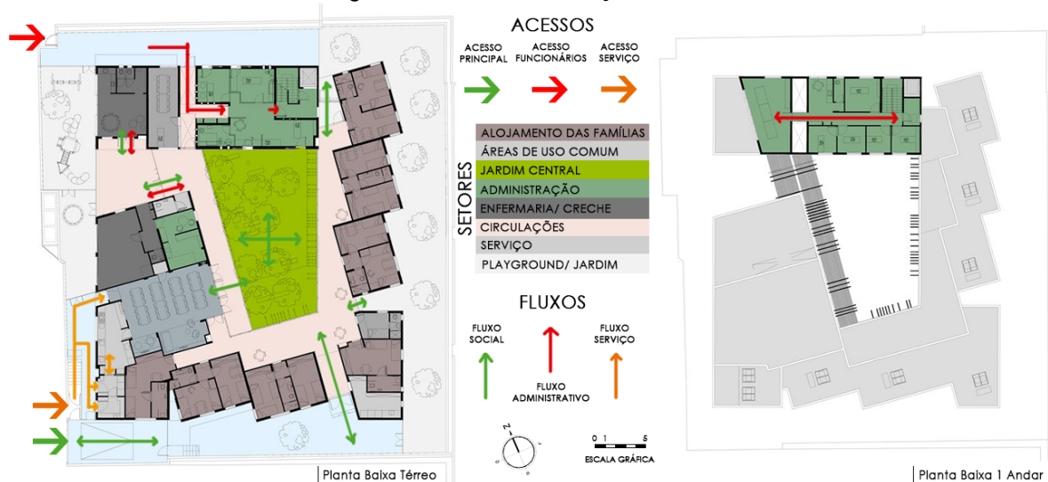
Fig. 17: Acessos, setorização e fluxos
