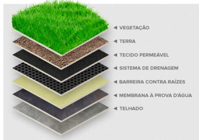
Figura 2: Estrutura básica dos telhados verdes.
