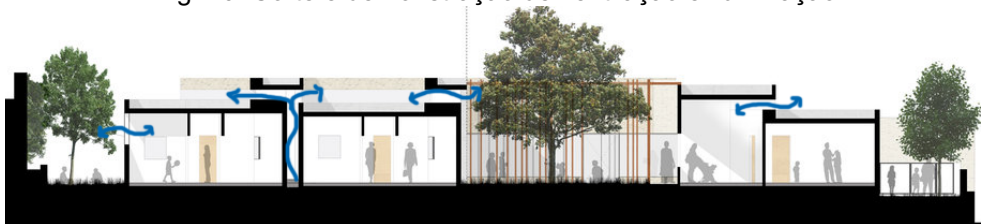
Fig. 20: Corte e demonstração de ventilação e iluminação
