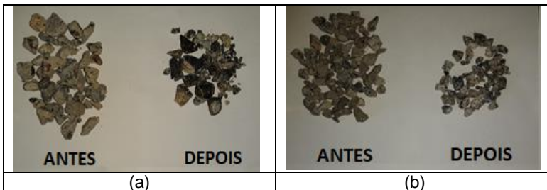
Figura 5 – Agregados reciclados antes e depois do ataque químico: (a) agregados do Grupo 1 e (b) agregados do Grupo 2.
