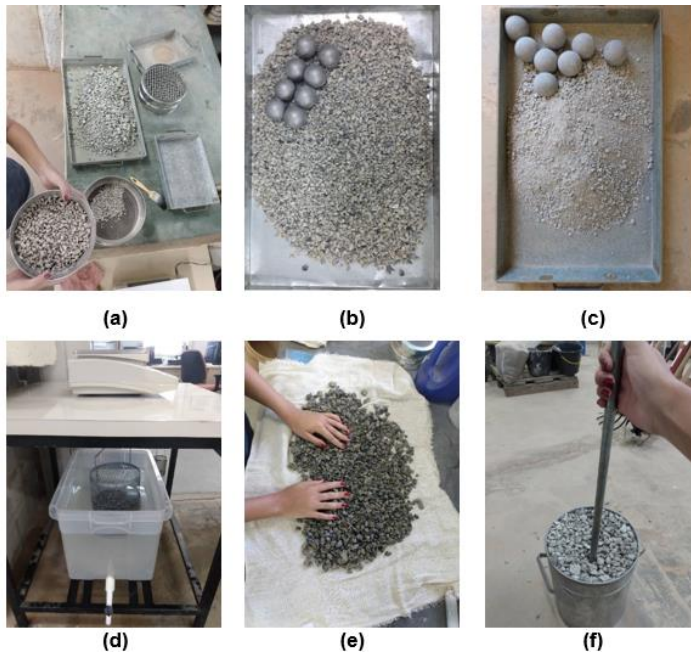
Figura 1- Caracterização dos agregados graúdos: (a) composição granulométrica, (b) amostra antes do ensaio de Abrasão Los Angeles, (c) amostra retirada do tambor do ensaio Los Angeles, (d) massa específica, (e) absorção de água e (f) massa unitária.
