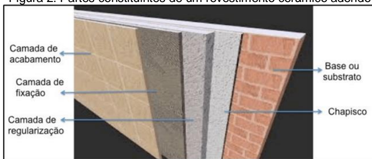
Figura 2: Partes constituintes de um revestimento cerâmico aderido
