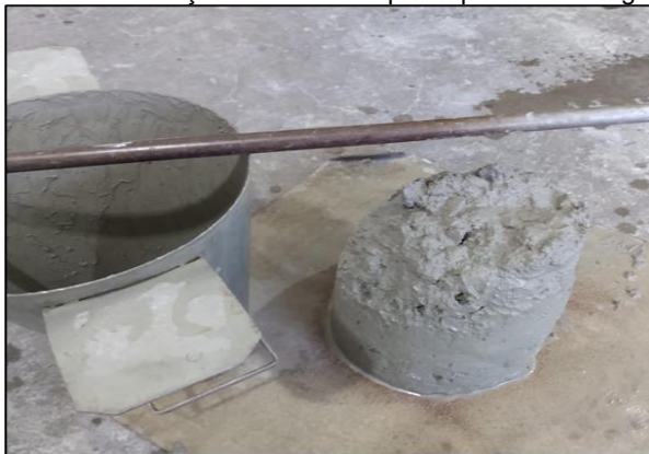
Figura 3: Abatimento do traço com 100% de pó de pedra como agregado miúdo
