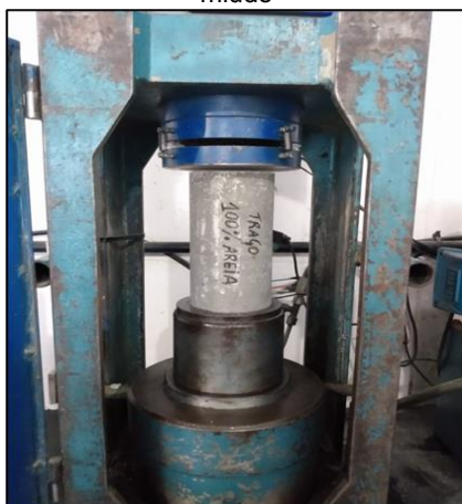
Figura 4: Ensaio de compressão do traço com 100% de areia natural como agregado miúdo
