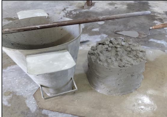
Figura 2: Abatimento do traço com 50% de areia natural e 50% de pó de pedra como agregados miúdos
