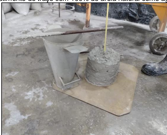
Figura 1: Abatimento do traço com 100% de areia natural como agregado miúdo
