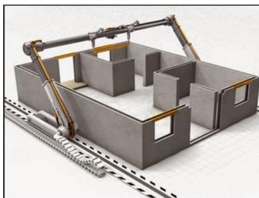
Figura 4: Impressora utilizada para a Contour Crafting .
