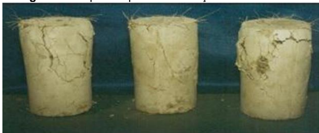
Figura 1: Corpos de prova com adição de fibra de coco
