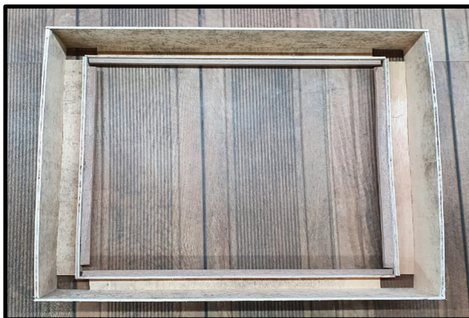
Figura 8 - Forma para laje de teste
