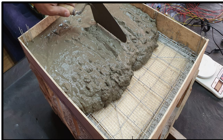
Figura 31 - Despejo de concreto na maquete final
