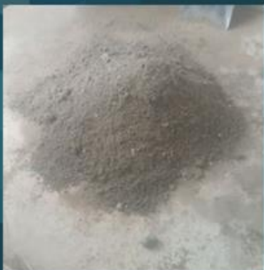
Mistura da areia e cimento
